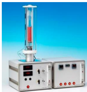
3. ábra: Oxigén index meghatározáshoz használt berendezés, amelynél az üvegcsőben áramló gázelegy összetétele szabályozható, a benne elhelyezett minta éghetősége állandósult állapotban mérhető
